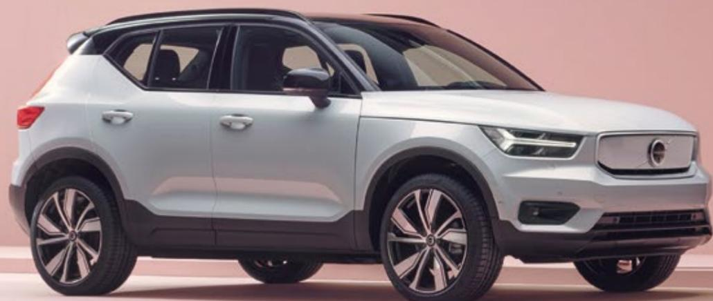
Pour son premier modèle 100% électrique Volvo a choisi son SUV compact XC 40 qui est donc le premier à bénéficier de la plateforme CMA (Compact Modular Architecture) dédiée à cette technologie. Classiquement maintenant pour les électriques, la plateforme accueille la batterie dans le plancher et un moteur électrique par essieu. A elle seule
